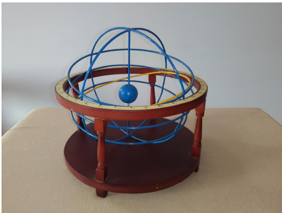
Figura No 31: Esfera armilar fabricada de manera artesanal. La “jaula esférica está apoyada en una base de madera que indica el Ecuador celeste y que sirve para inclinar la esfera de acuerdo a la latitud del observador. La esfera azul en el centro representa la Tierra (herramienta didáctica de mi colección)
