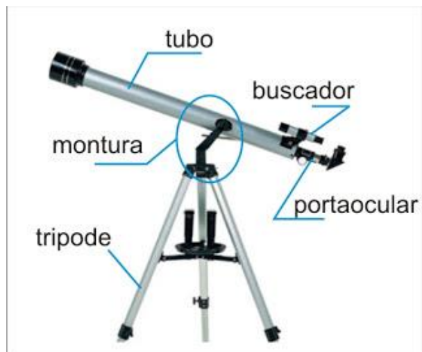
Figura No 12: Telescopio refractor. Consiste de un tubo largo a través del cual la luz viaja desde el lente frontal hasta el ocular. Éste tipo de telescopio es recomendado para observar la Luna, los planetas y estrellas binarias. (Infobservador, 2010)
